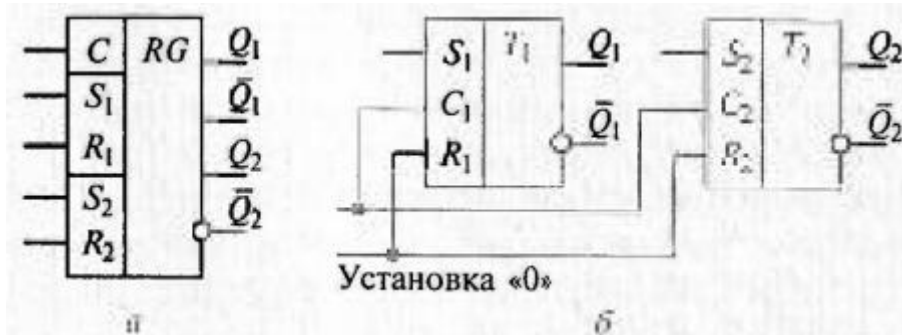
Рис. 5.6. Умовне графічне зображення (а) і функціональна схема (б) дворозрядного регістра
