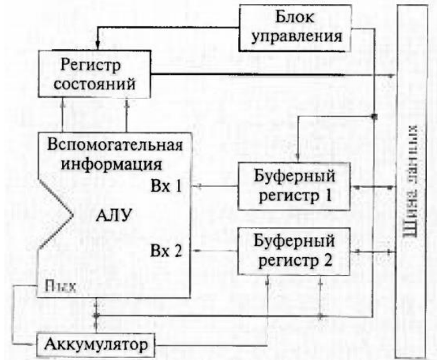
Рис. 4.10. Підключення АЛУ до зовнішніх регістрів
