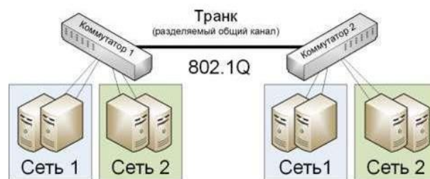
Рисунок 4.15 – Віртуальні локальні мережі (VLAN) з використанням двох комутаторів
