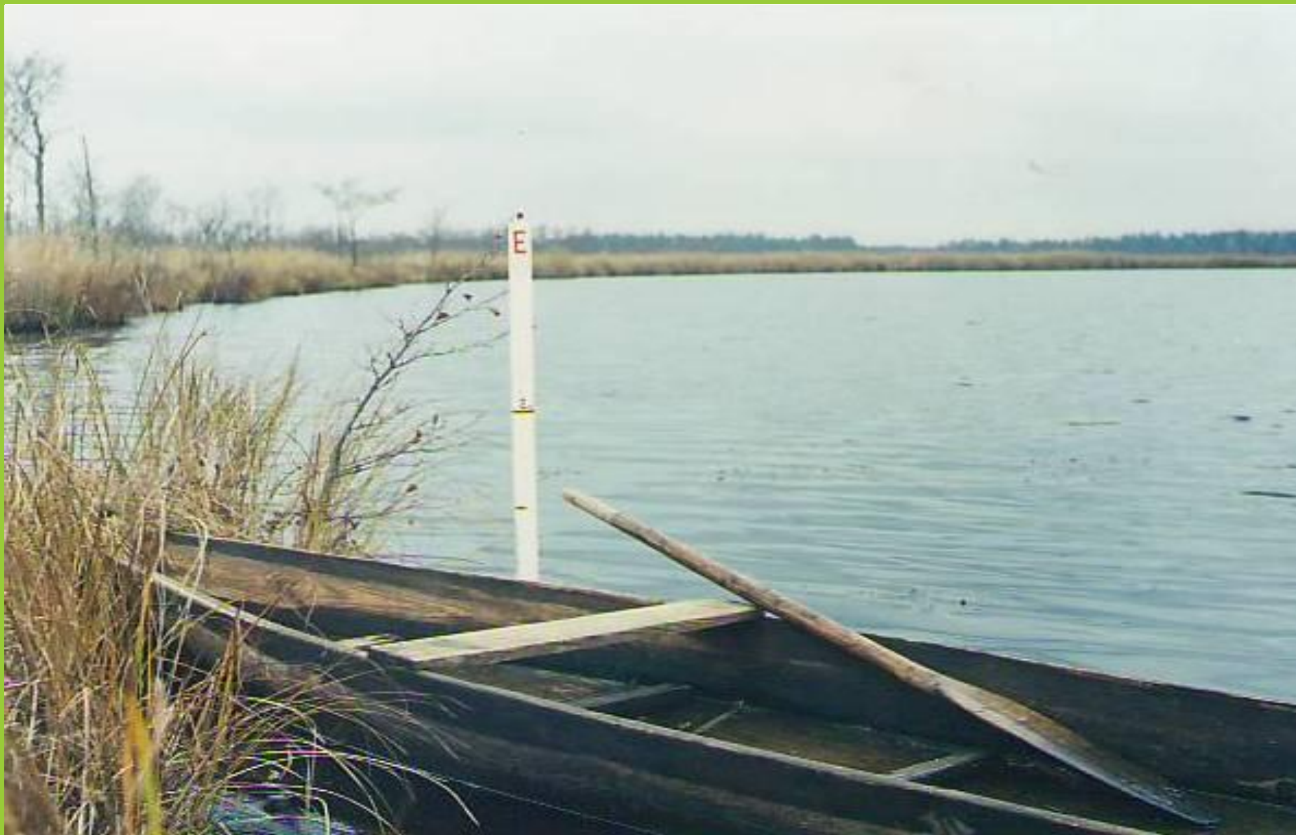
Стационарна водомірна рейка для гідрологічних спостережень на Черемському озері
